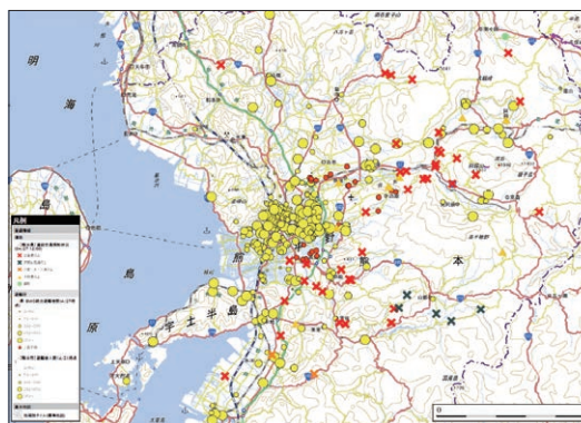
SIP4Dで、複数の機関や部署が持っている道路通行情報と避難所の情報を1枚の地図上にマッシュアップし、すべての災害対応機関が使える地図を作成。2016年の熊本地震や17年の九州北部豪雨でも有効性を実証できた
